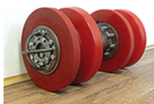
Манжетно-дисковое очистное устройство «ВОСТОК-МД» с установленным спереди регистратором «ВОСТОК-ВР» перед испытаниями.
